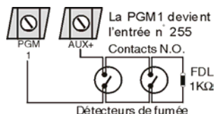
Figure 2-8 : Détecteurs à 2 fils
